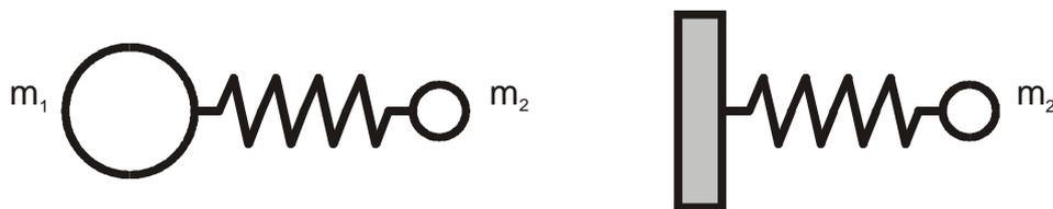
Bild 2.2: Modell des zweiatomigen Moleküls als Federschwinger (links) und Näherung für  $m_1 \gg m_2$  (rechts)
